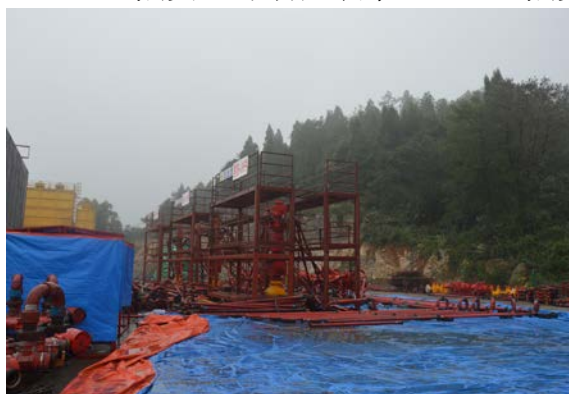
焦页 6#平台压裂作业区底部铺防渗
