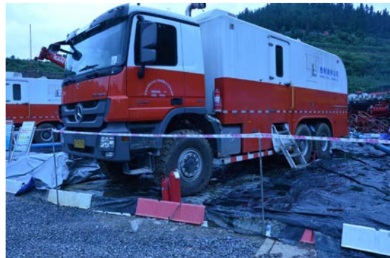
压裂设备围堰+防渗
