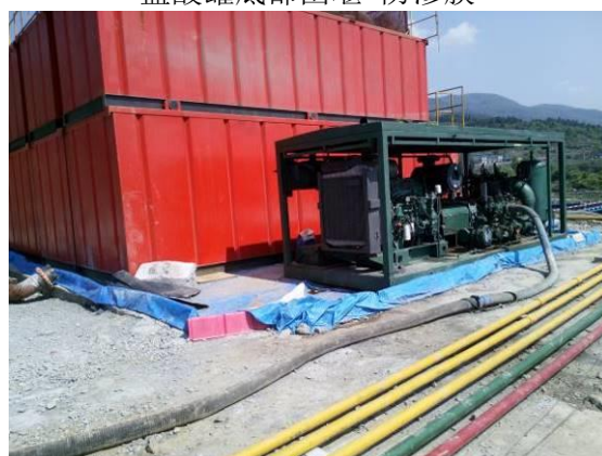
压裂设备防渗+围堰
