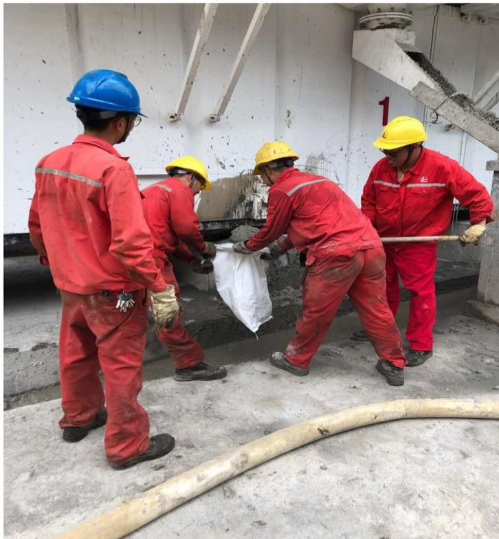
演练记录 1: 70635JH 队钻井一班泥浆工发现循环罐区处有泥浆外泄,立即使用对讲机通知司钻,司钻立即停止钻进并组织全班人员进入预案程序。值班干部通知干部大班,组织人员对外溢泥浆进行拦堵、回收、清理。
