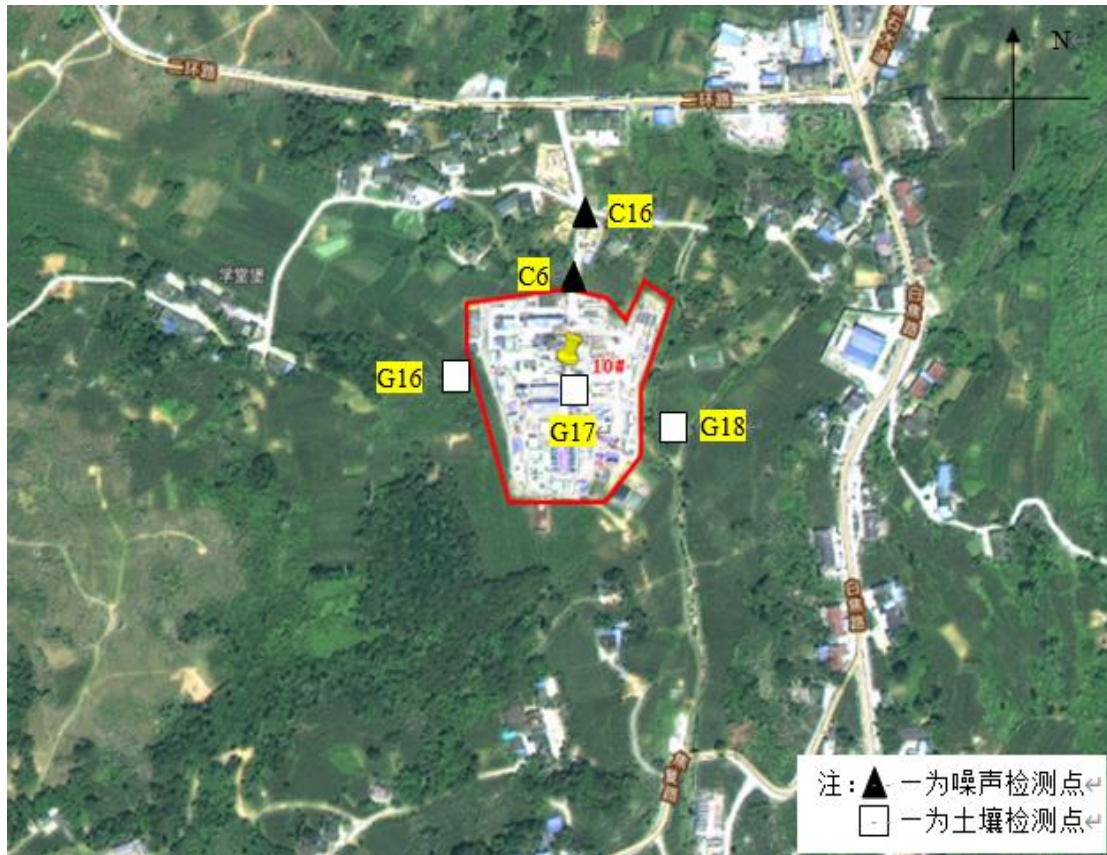
图 8-4 焦页 10#平台检测布点平面示意图
