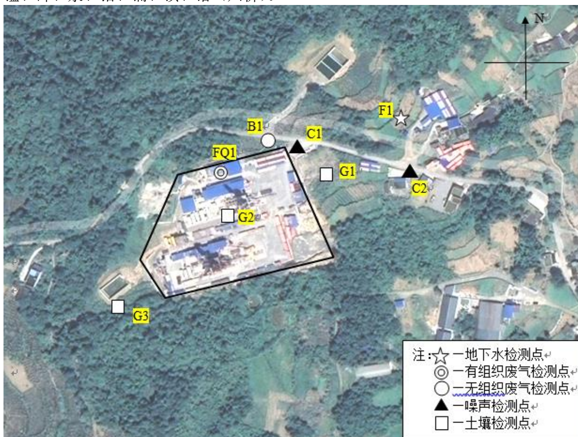
图 8-2 土壤、地下水、噪声、大气环境监测布点示意图
