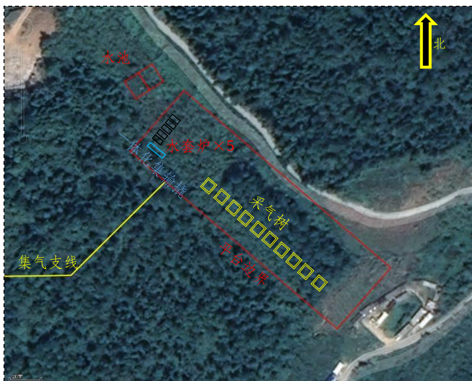
图 2.1-9 焦页 18 号东平台集输工程平面布置示意图
