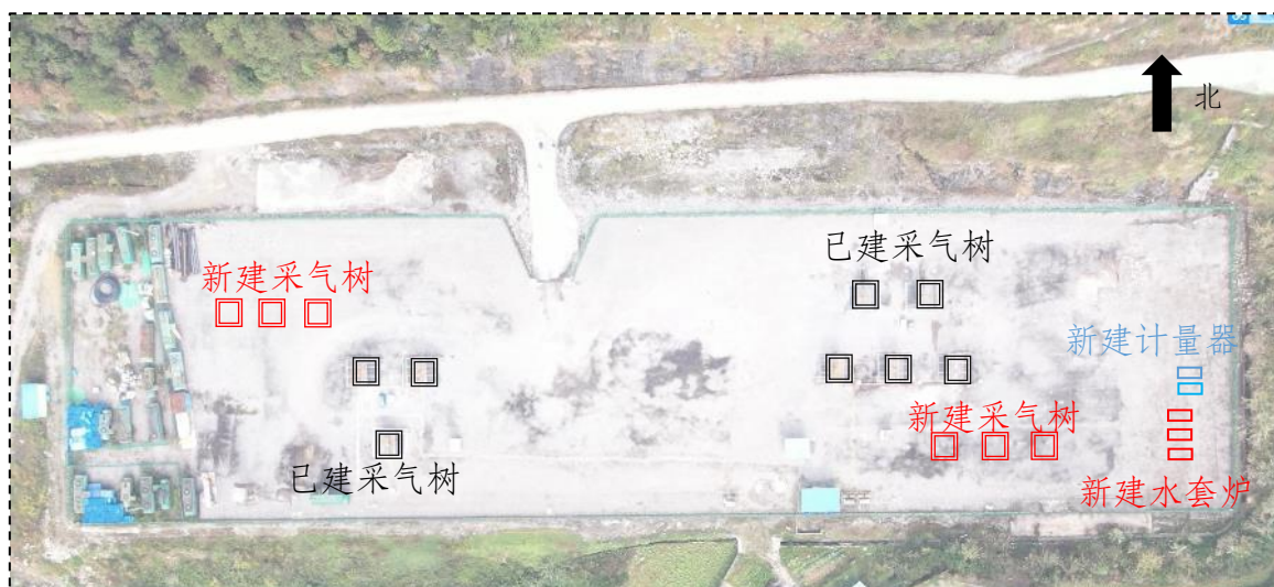
图 2.1-11 焦页 19 号扩平台集输工程平面布置示意图
