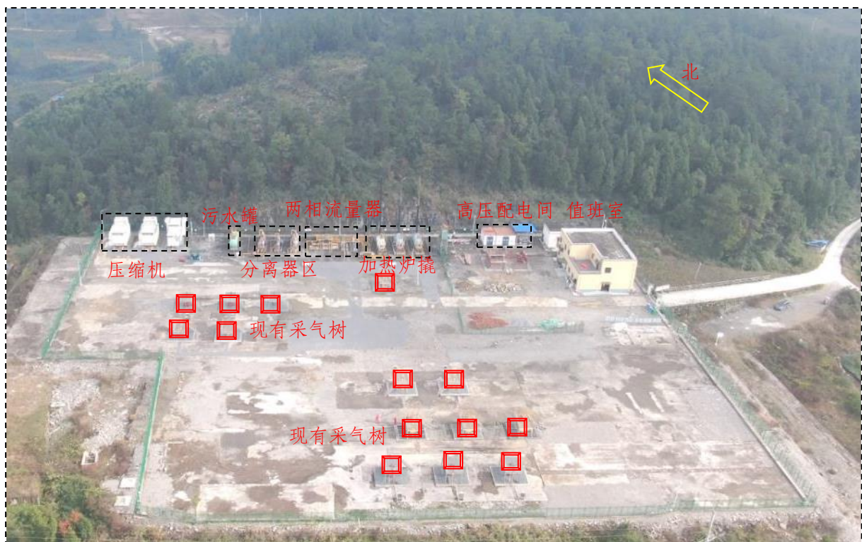
图 2.1-2 焦页 18 号集气站平面布置现状图
