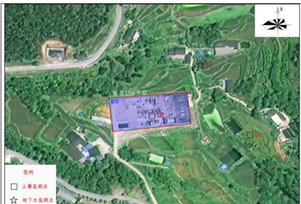
图 8-2 土壤地下水环境监测布点示意图
